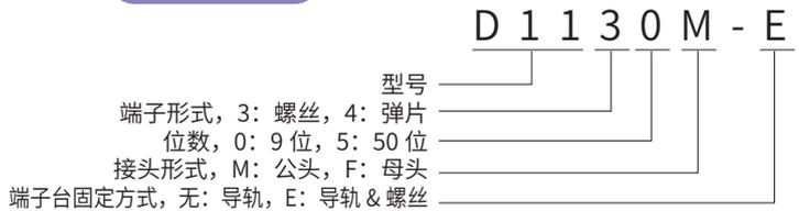
注: 带 E 安装左右中心距 = 端子台长度 + 7.7mm
